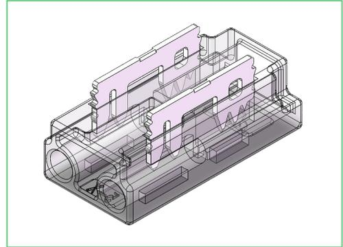
Lötfreier 2-poliger LED Verbinder für 5 mm COB Streifen – ohne Kabel.
